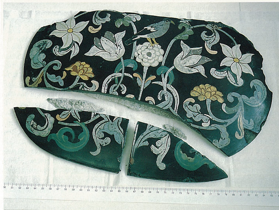
11 Einen Bruch der Platten bewirkten vor allem die Spannungen des Rahmens.
